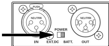
(電池使用時にはEXT. DC側、ACアダプター使用時にはBATT. 側に切り換えることで電源を切ることができます。
