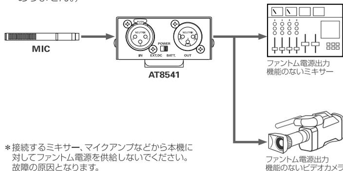
\*接続するミキサー、マイクアンプなどから本機に対してファントム電源を供給しないでください。故障の原因となります。
