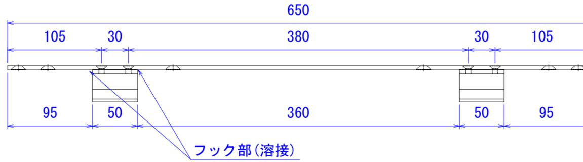
※本製品は重量物のモニターが掛かる為、M6の皿ねじとナット固定及び溶接にてフックを固定する仕様になります。
